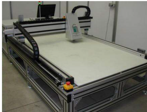
FIGURE 1.4 – Contrôle micro-onde de matériau composite plan [16].
